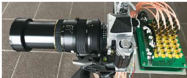
光無線通信実験装置(送光部-写真上、受光部-写真下) (光MIMO方式による世界最高の速度距離を達成)
