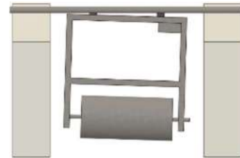
図5 水車装置の傾斜設置 (今年度)
