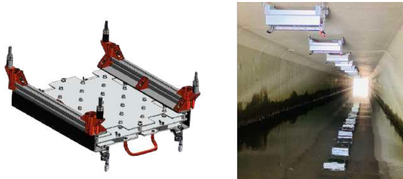
図-1 樋管内に簡便な操作で原子核乾板の設置を可能とする専用治具と設置状況
