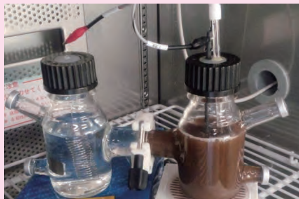
硝酸除去用生物電気化学システム、右側の茶色の物質が細胞外電子伝達物質
