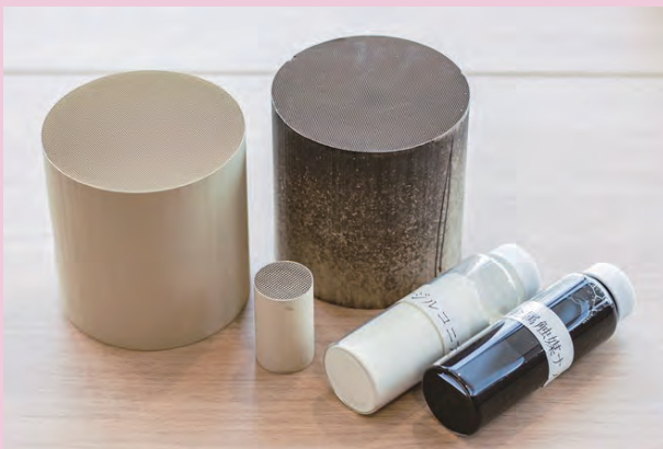
ハニカム/左は使用前、右はエンジン排ガス検査で実際に使用した後。下の2本は触媒のセリアジルコニア材料と貴金属のナノ粒子溶液
