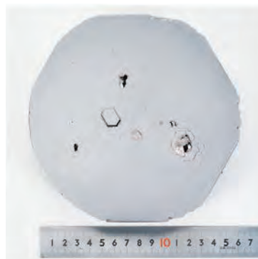
コンピュータ内に再現した結晶成長装置で最適化を行い圧倒的に短い期間で6インチSiC基盤を実現
