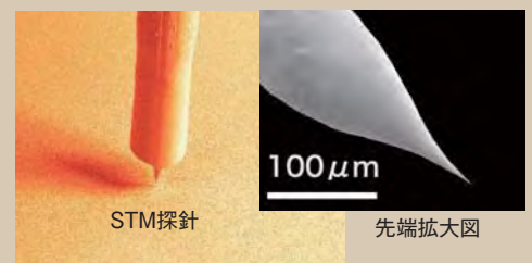
STM探針と試料表面の走査電子顕微鏡像
