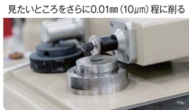
見たいところをさらに0.01mm(10μm)程に削る
