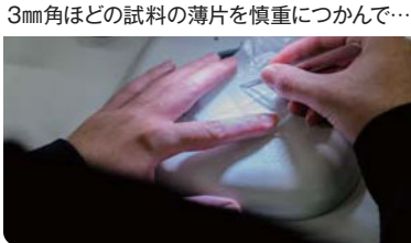
研磨板を替えながら厚さ0.1mm位に薄くする
