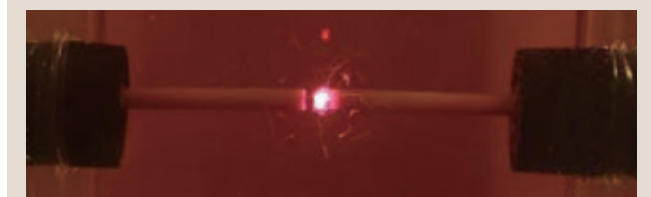
SPP法により、金属ナノ粒子が電解質溶液中に生成される。高分子干渉材を用いることなく凝集(原子などが多数集まって集塊となること)せず、粒径20nm以下任意のナノ粒径の状態を長期保つことが可能。
