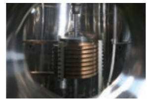
【表紙写真説明】 SiC結晶成長の装置の要部分である「るつぼ」を、高温にさせるためのコイル。(→P05 参照)
