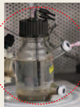
上:微生物による下水の処理(分解)を、電気で促進する実験。電気などの条件をどう風に変えたら汚染物質がどう風変わっていくかを上部のモニターでチェック。 左:下に溜まっているのが微生物の塊。その部分に届くように棒を挿し、電気を流して変化を観察。
