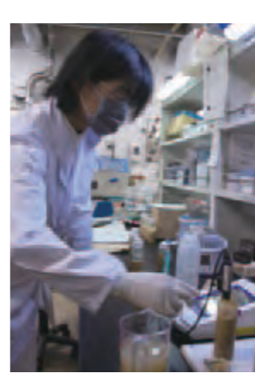
粘土のpH測定をするために、採取してきた物に電極を差している。
