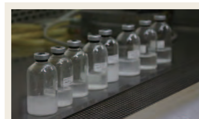
瓶の中に目的の微生物にとっていい環境(培地)を再現して微生物を培養。
