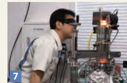
熱分解によりSiの成分が抜けてCのみからなるレイヤーができる
