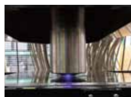
【表紙写真説明】 2015年から使用している超高速自動飛跡読取装置(HTS=Hyper Track Selector)のレンズ部周辺。読み取り中の様子。レンズとフィルムの間に空気が入ると分解能が悪くなるため、フィルムと同じ屈折率のシリコンオイルをレンズとフィルムの間に充てている。
