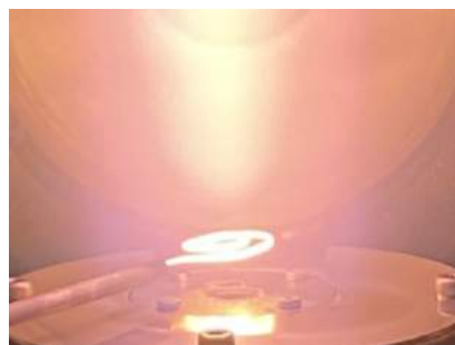
図 1 APSEDAS におけるヘリウムプラズマ-タングステン共堆積実験の様子
