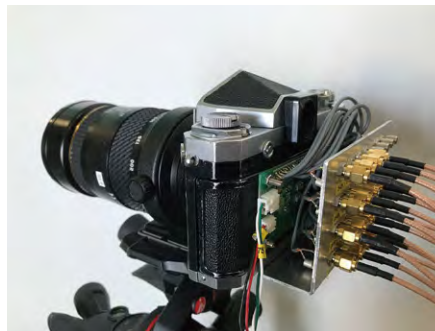
イメージング MIMO 光無線用受光器 Imaging Optical Device for Wireless Communications
