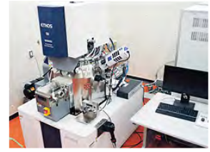
バイオ/無機材料用高FIB-SEM システム ETHOS NX5000 High-speed sample fabrication/analysis system ETHOS NX5000
