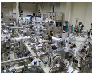
スパッタ/MBE/ ECRエッチング真空一貫システム Sputtering/MBE/ ECR etching system
