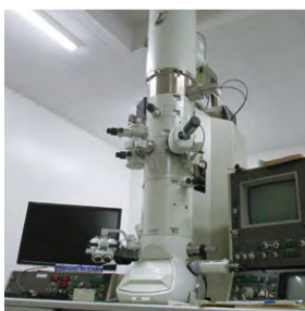
透過電子顕微鏡システム JEM-2010F Transmission electron microscope JEM-2010F
