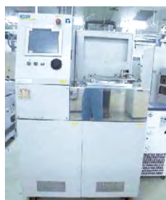
ICPドライエッチャ1 samco RIE-200IP ICP etching system 1 samco RIE-200IP
