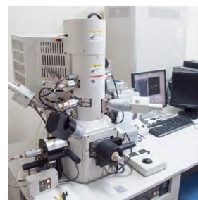
集束イオンビーム加工機 FB-2100 (FIB) Focused ion beam sample preparation system FB-2100
