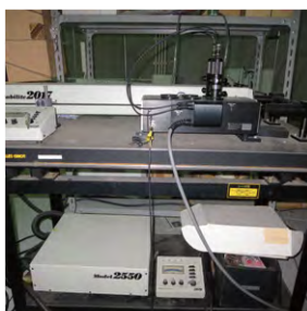
1成分レーザドップラー 流速計測装置 FSA3500P Laser doppler velocimeter for one velocity component FSA3500P
