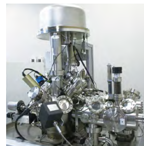
X線光電子分光装置 ESCALAB250Xi X-ray photoelectron spectrometer ESCALAB250Xi
