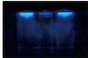
化学ルミネッセンスによる超音波化学反応場の可視化 Chemical luminescence in a sonochemical reactor
