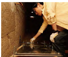
クフ王のピラミッド内の回廊に原子核乾板を設置する様子 Nagoya University emulsion film setup in the descending corridor
