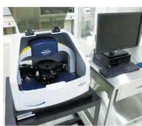
接触式表面形状システム Bruker Dektak XT-A Stylus profiler Bruker Dektak XT-A
