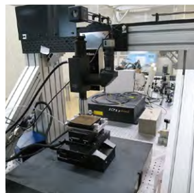
フェムト秒レーザー 加工分析システム Femto-second laser for micro-fabrication and measurement
