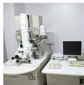
電界放射型分析走査電子顕微鏡 JSM-6330F Field-emission scanning electron microscope JSM-6330F
