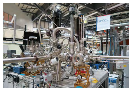
あいちシンクロトロン (BL6N1) の放射光XAFS-XPS分析装置 XAFS-XPS analysis system in Aichi SR (BL6N1)
