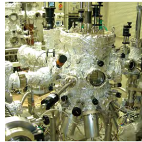
8元マグネトロンスパッタ装置 Magnetron sputtering with 8 sources
