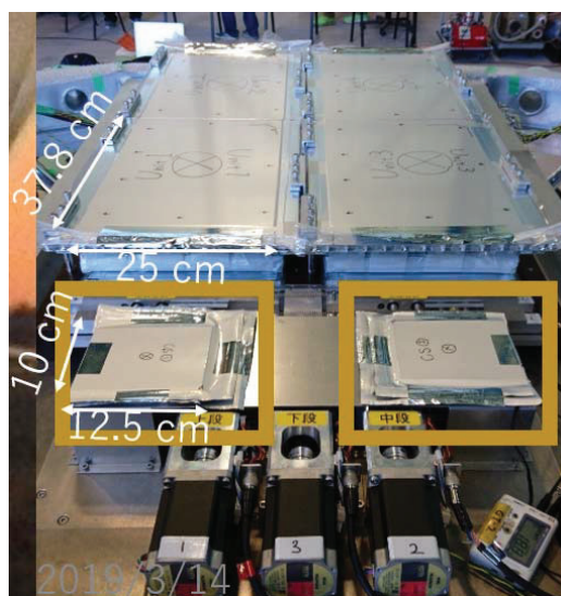
図 1 ゴンドラ内に設置された減感原子核乾板から構成される宇宙線原子核観測用チェンバー
