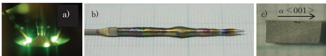
Fig. 1 a) \alpha -FeSi 2 引き上げの様子, b) \alpha -FeSi 2 単結晶棒, c) ラウエ法で方位を決め \alpha -FeSi 2 の c 軸方向に切り出した試料
