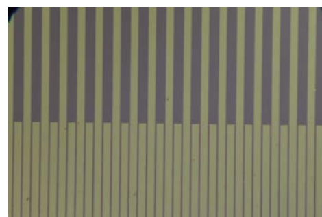
図 3 : 作製した楕形電極の光学顕微鏡像
