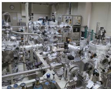
スパッタ/MBE/ECRエッチング真空一貫システム Sputtering/MBE/ECR etching system
