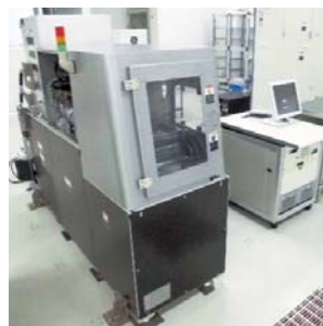
スパッタ装置 ULVAC CS-L Sputtering system ULVAC CS-L
