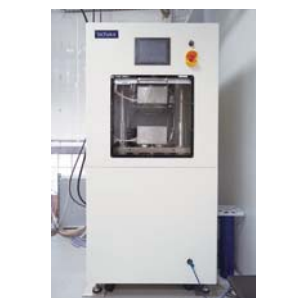
ナノインプリント サイヴァクス X500 Nano inprint equipment SCIVAX X-500
