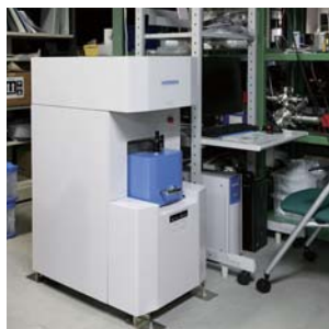
イメージングCL HORIBA WD201N Imaging CL HORIBA WD201N
