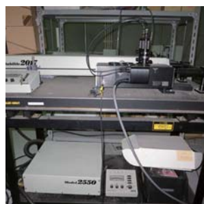
1成分レーザドップラー流速計測装置 Laser doppler velocimeter for one velocity component
