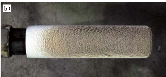
b) 灰付着炉にて30分曝露後の伝熱管試料外観写真 b) Picture of ash deposition after 30 min
