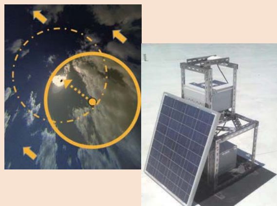
全天画像を用いた配電エリアにおける太陽光発電の把握・予測システム Nowcasting/Forecasting System of Photovoltaic Power Generation in Distribution Network using All-sky Images
