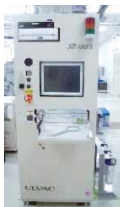
ICPドライエッチャ3 ULVAC NE-550EX ICP etching system 3 ULVAC NE-550EX
