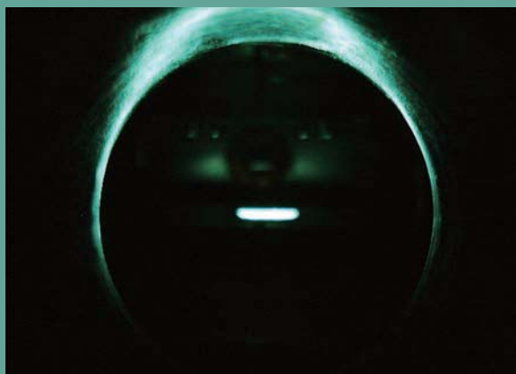
シンクロtron放射光の蛍光粉末からの光 Synchrotron light from fluorescence powder.
