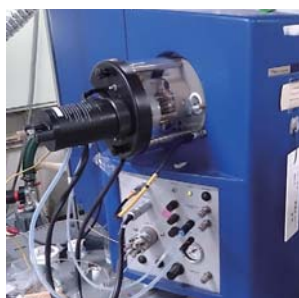
ナノ構造解析用液体クロマトグラフ質量分析計 Liquid chromatograph/mass spectrometer
