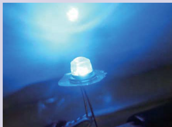
青色発光ダイオードの試作例 Prototype of Blue LED
