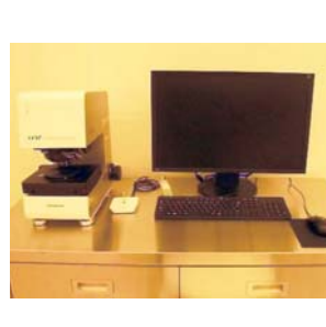
レーザー顕微鏡 オリンパス OLS-4100 Laser Confocal Microscope Olympus OLS-4100
