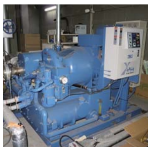
電動式小型遠心圧縮機試験装置 Test apparatus of electrically driven small centrifugal compressor
