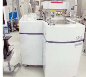
ICPドライエッチャ4 ULVAC CE-S ICP etching system 4 ULVAC CE-S
